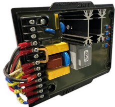
Genauigkeit Automatischer Spannungsregler mit dreiphasiger Messung (AVR) +-1%.
